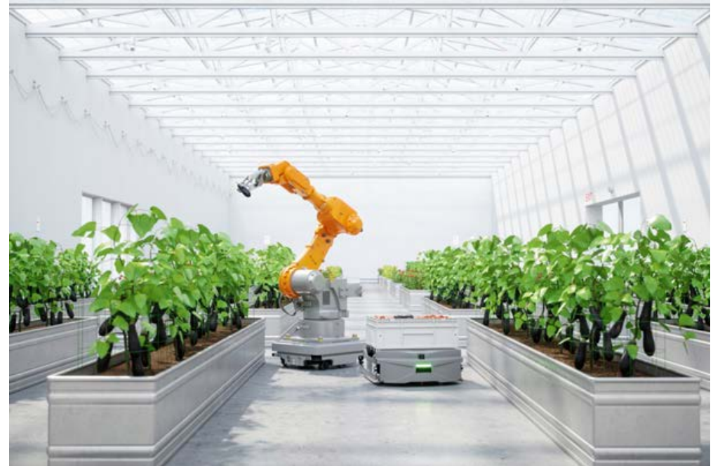
Figuur 2.4 Mobiele plukrobot
